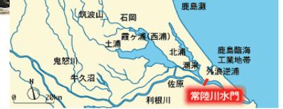
現在、常陸川水門により塩分の遡上を防止することにより、水門下流の塩分約400~12,000mg/lに対し、水門上流の塩分は年平均で約150mg/lとなっており、水門上流のたくさんの取水口から取水され、製氷、工業、上水に利用されています。 ※水質基準(塩化塩イオン200mg/l以下)
