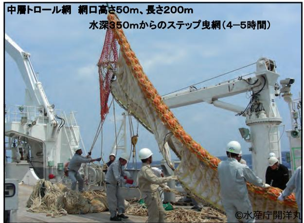
中層トロール網 網口高さ50m、長さ200m
