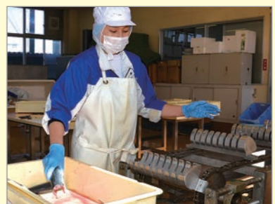
水洗いしたサバを機械で裁断する。
