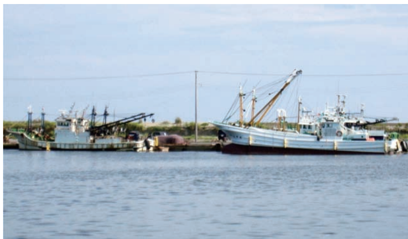
写真 1 2艘まき中型まき網船団：左が 14 トン型網船 2 隻、右が 19 トン型運搬船
