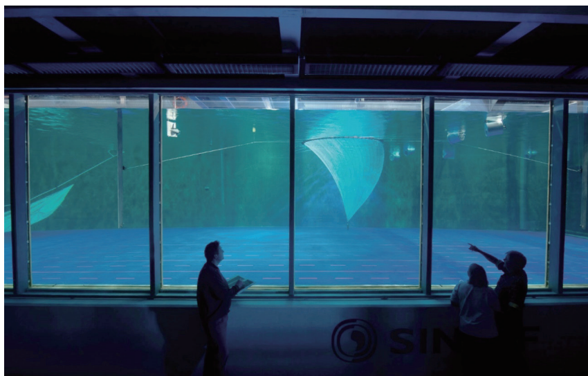
図2-7 Egersund Net では網なりを顧客と確認しながら最終的な形状を決める。 （Credit: AKVA Group ASA, 同社より許諾を得て掲載。）
