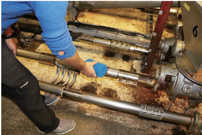
図2-11 スポンジを投入して風圧で押し出しパイプ内を清掃。給餌のベストパフォーマンスを出すために常に装置の手入れを欠かさない、という。
