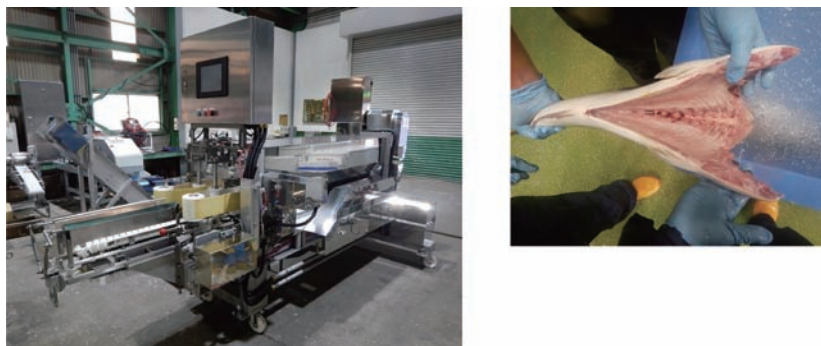
写真2 高速内臓除去装置と内臓を除去したブリセミドレ
