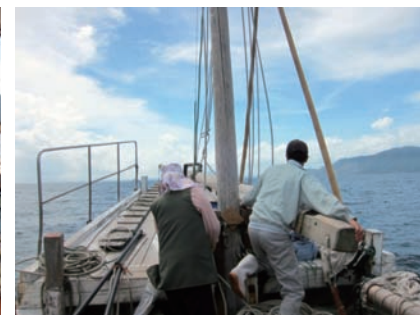
写真 28 漁場に到着すると船内に格納していたビームを船首・船尾に突出し固定する。
