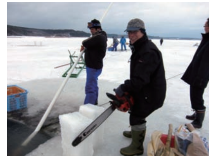
写真11 氷に穴を開ける道具は、ブレードの長いエンジンチェーンソー。
