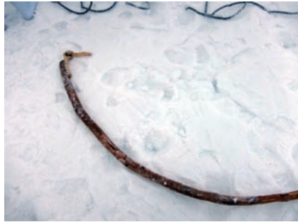
写真 16 ガイドロープを引っかけるための手カギ、栗の木の枝分かれ部位を利用して自作。
