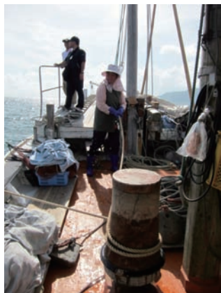
写真 32 揚網はこの大型のウインドラス（ローラー）で巻き揚げる。これによって網揚げの労力が削減され、2人での操業が可能となった。
