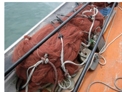
写真 30 漁網の1セット。黒い樹脂性のポールは網口を広げる張り棒、錘は自然石を平らに加工している。
