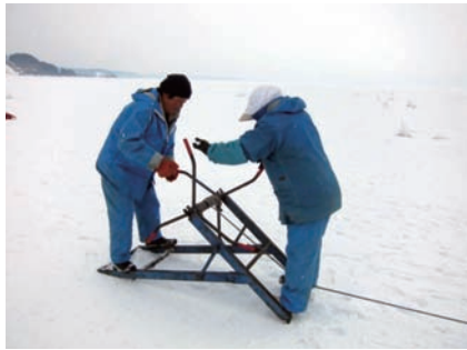
写真8 ジョレンに結束したロープをカグラサン（巻上機）で巻き上げる。重いので作業は2人かかり。
