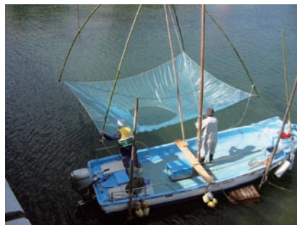
写真41 四手網を揚げるところ。大きな網を操作するため、船舶はシンプルな船形状。
