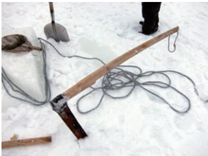
写真 17 割った氷を引き上げるツルハシのような道具、かつてチェーンソーの無い時代、このツルハシで穴を開けていた。その他手網、ガイドロープなど。
