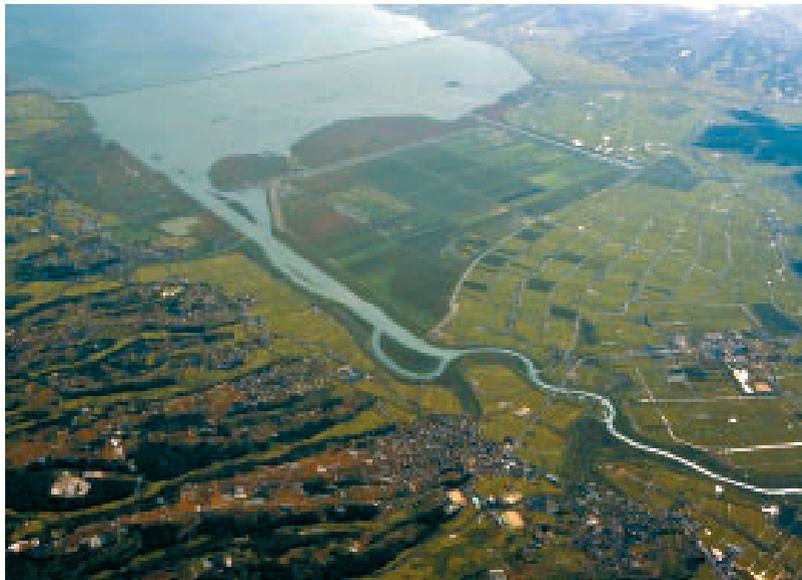
図 15 諫早湾干拓地と調整池の空撮（九州農政局 HP より引用）右下から左上へ本明川が流れ、上部に潮受け堤防があり、内側が調整池、外側が諫早湾である。
