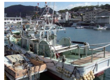
(ネットドラム巻き取り方式まき網漁船)
