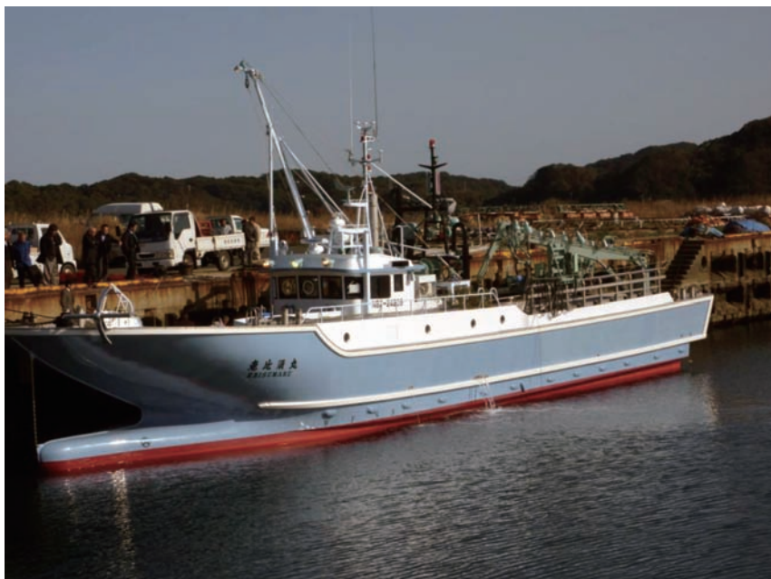
○五島奈留中型まき網地域プロジェクトで新船建造された改革型漁船 （旧船 19 トン型網船 新船は活魚輸送機能を持つ 19 トン型網船）
