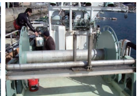
(ネットドラム巻き取り方式まき網漁船)
