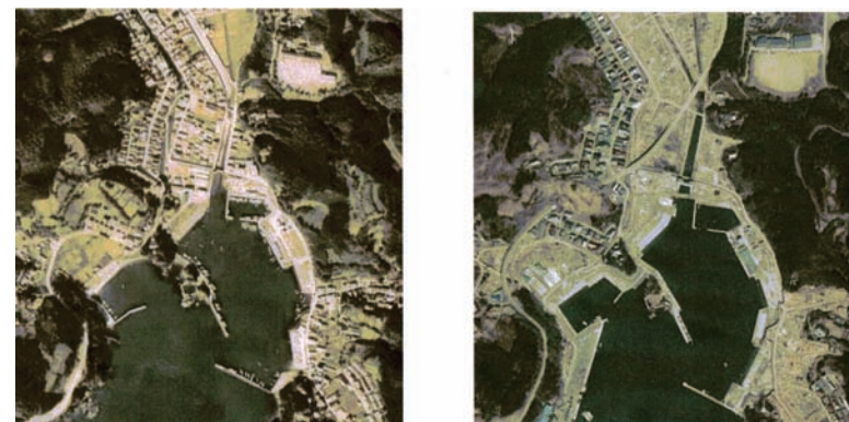
（被災前；昭和52年10月撮影） （被災後；平成23年4月1日撮影） 注；綾里地区のうち昭和三陸地震津波の際に嵩上げ造成された高台宅地のみがくっきりと被災を免れて残っているのが分かる
