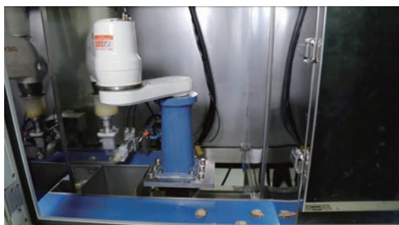
ホタテのウロをロボットにより分離
