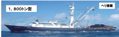
アジア標準船(台湾・韓国・中国・フィリピン) 長さ80m(日本は4隻のみ) 魚艙容積 約1,200トン
